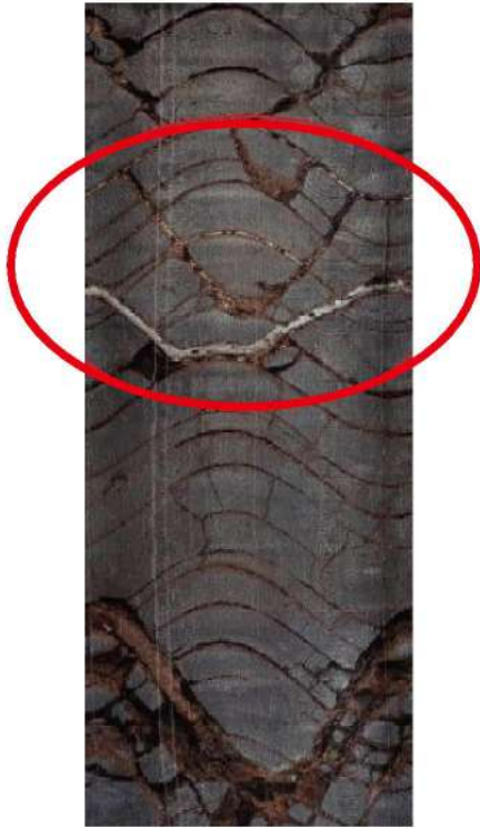
ダムサイトでの セメントミルク注入後
